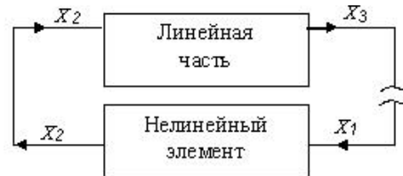
Рисунок 1.8 - Структурная схема системы с нелинейным элементом
